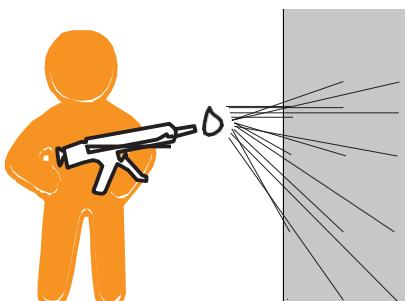
Panelene kan limes eller skrues på vegg / i tak eller kombineres. Ved bruk av lim: Punktlim panelet på baksiden. Trykk mot vegg. Beregn en halv tube per panel.
