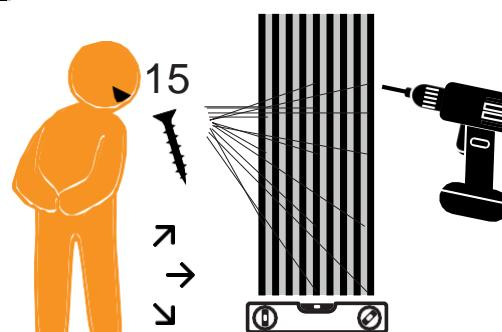
Ved montering med skruer monteres panelene på vegg eller i tak ved å feste Fibrotechs skruer i akustikkfilen mellom ribbene. Det anbefales å bruke 15 skruer per panel. Bruk alltid vater for å kontrollere at ribbepanel monteres rett.
